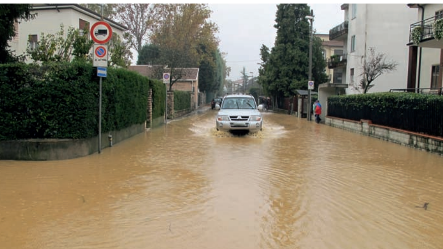
La saturation des réseaux d'assainissement des eaux pluviales lors d'orages violents résulte de la réduction progressive des surfaces d'infiltration en zone urbanisée.
