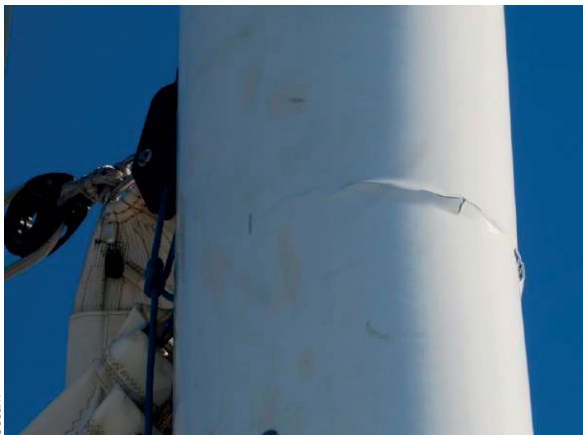
Fissures sur le mât.
